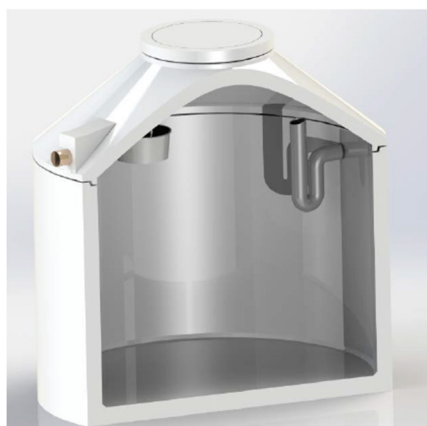
Obr. 2: Filtr Evo Basic namontovaný uvnitř betonové nádrže
